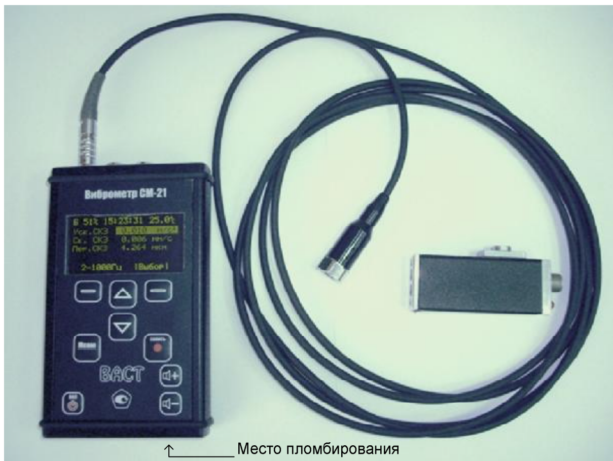
Рисунок 1. Внешний вид и место пломбирования виброметра СМ-21
