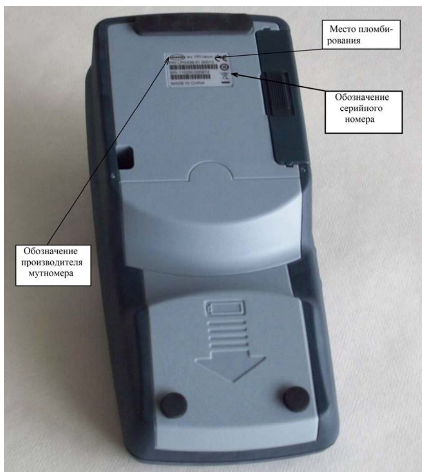
Рисунок 2 - Вид нижней стороны мутномера с обозначением схемы пломбирования и маркировки
