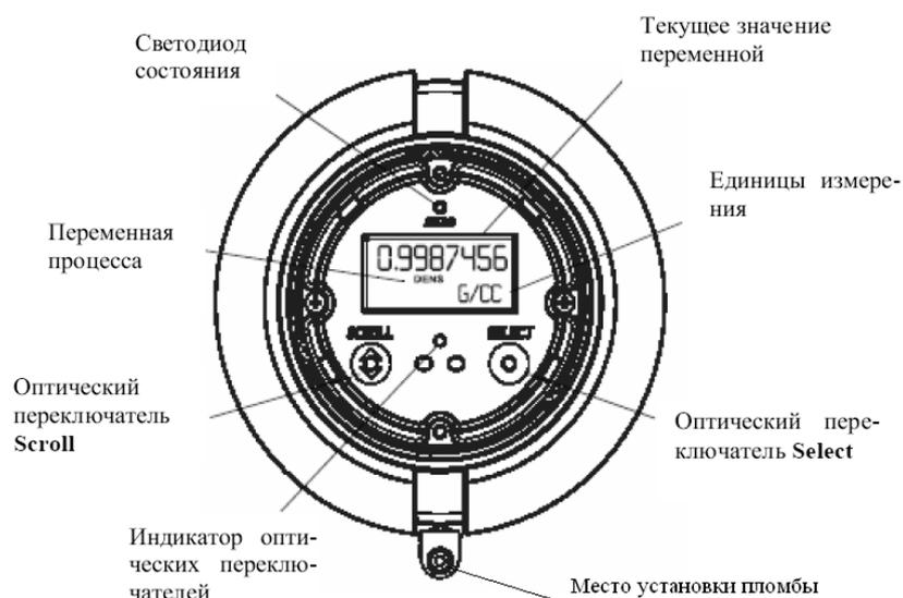
Рис. 2. Место установки пломбы от несанкционированного доступа на счетчики-расходомеры массовые Micro Motion.
