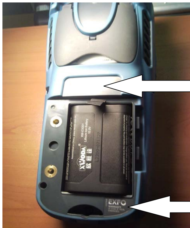
Рисунок 2 - Схема пломбирования от несанкционированного доступа
