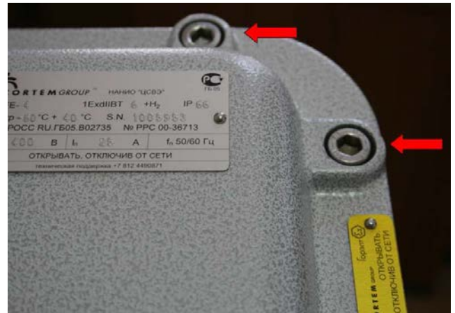
Рисунок 2 - Места размещения пломбирующих наклеек на вычислителе ВИТ УВП-001
