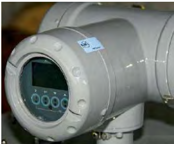
Рисунок 3. Пломбирование корпуса прибора.
