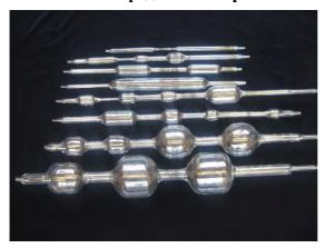
Пипетка представляет собой стеклянную трубку с одним или несколькими цилиндрическими расширениями. Нижняя часть пипетки - сливной кончик - имеет конусообразную форму. Верхняя кромка пипетки соответствует нулевой отметке. На пипетке нанесены круговые отметки в плоскости, перпендикулярной оси пипетки. Все отметки имеют цифровые значения. Отметки соответствуют значениям вместимостей на поверяемом отстойнике с учетом допускаемого отклонения.
