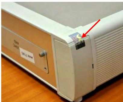
Рисунок 2а - Место для пломбировки от несанкционированного доступа
