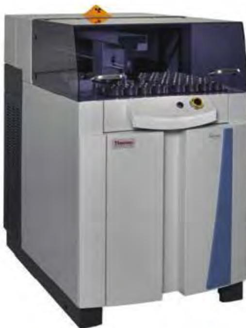
Рис.1 Спектрометр рентенофлуоресцентный ARL Perform'X 4200
