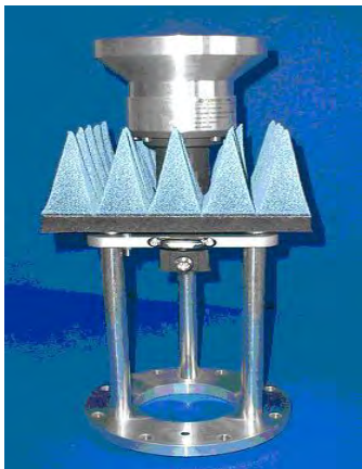
Рисунок 3 - Фотография общего вида рупорных облучателей зеркала радиоколлиматора
