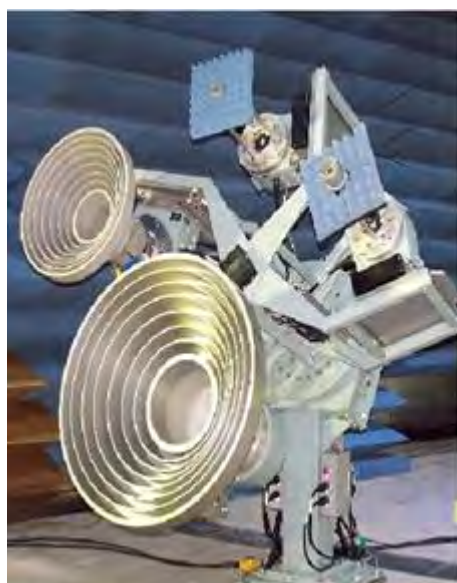
Рисунок 2 - Внешний вид ОПУ карусельного типа с облучателями зеркала радиоколлиматора (слева), без облучателей (справа)
