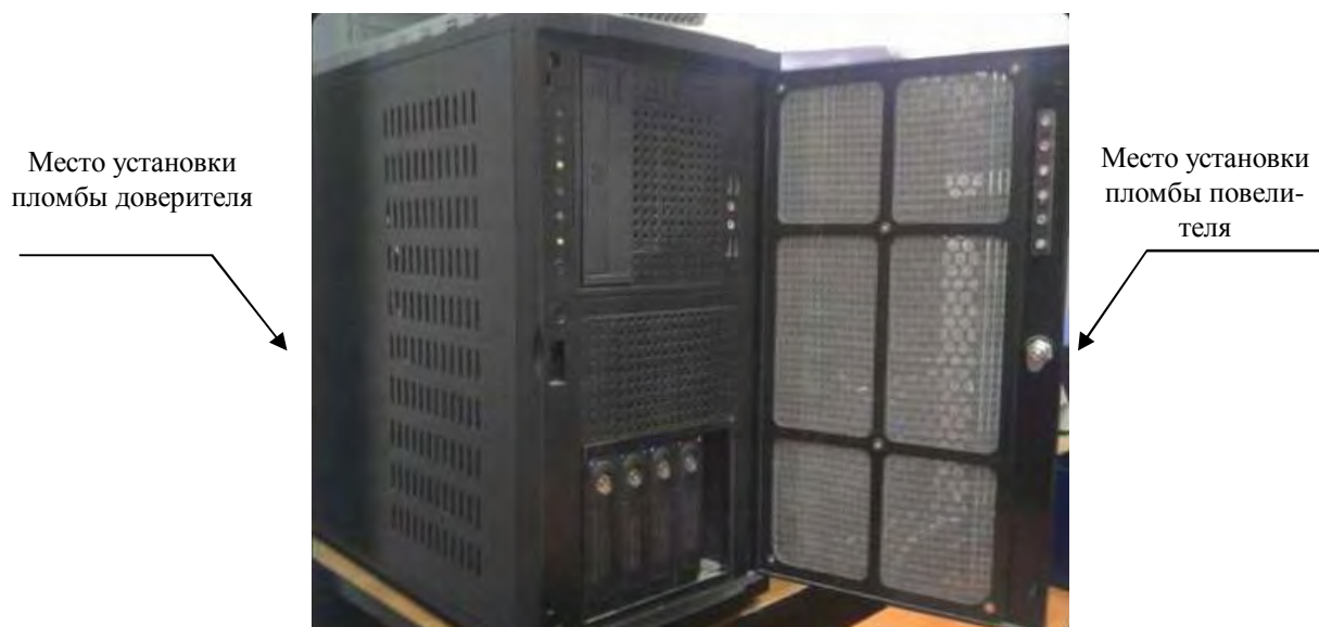
Рисунок 1 – Общий вид и места установки пломбы поверителя
