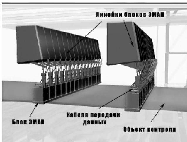
Рисунок 1 – измерительный модуль установки ультразвукового контроля листового проката автоматизированной «УЛЬТРА-РЕ75Р.002»
