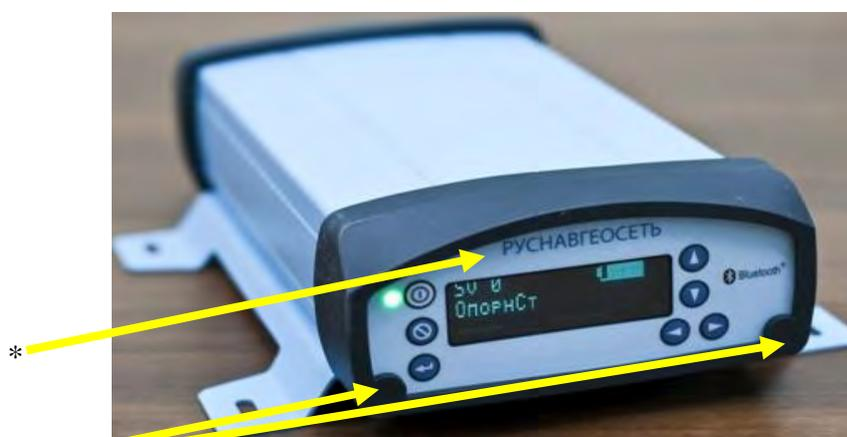
Места пломбировки от несанкционированного доступа.
