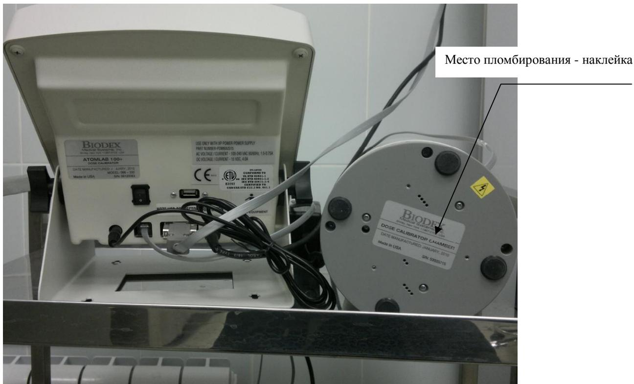
Рисунок 1б — Место пломбирования от несанкционированного доступа
