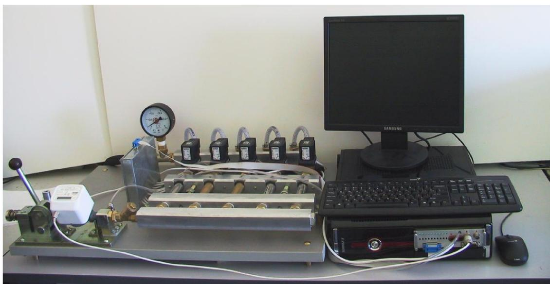
Программное обеспечение «Стенд СГ» (далее ПО) предназначено для управления установкой, получения от нее результатов измерений, расчета калибровочных коэффициентов, программирования электронных блоков счетчиков газа, расчета погрешности счетчиков газа, отображения и сохранения результатов.
