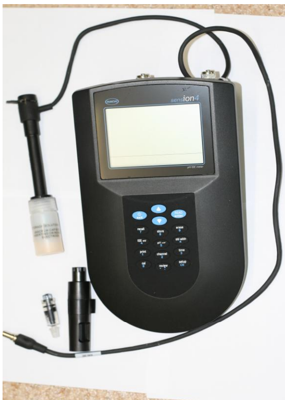
Внешний вид рН-метра лабораторного модель SensION 4.
