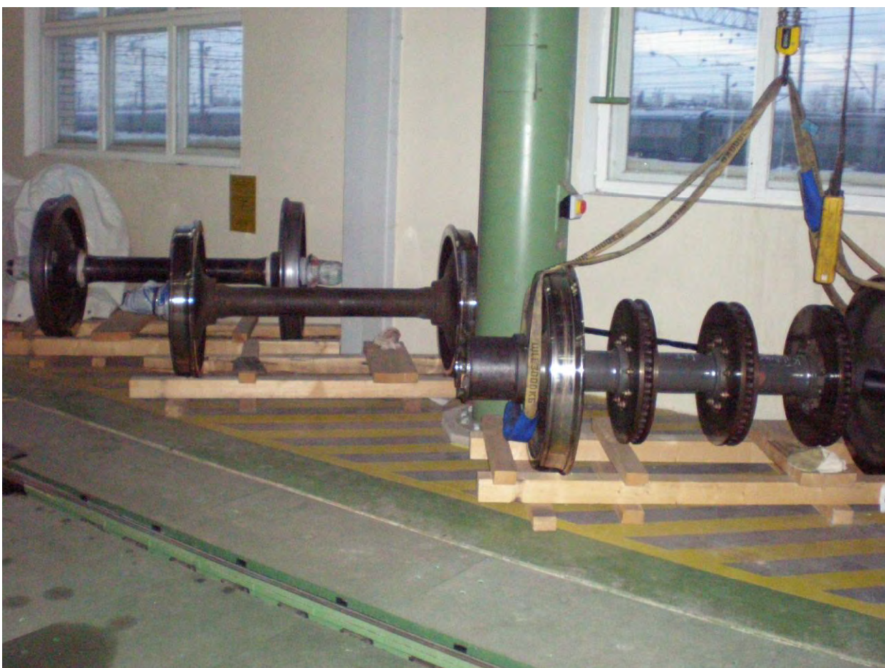
Рисунок 2 - Общий вид колесных пар для поверки измерительных модулей комплекса ARGUS 2, предназначенных для измерений геометрических размеров колес
