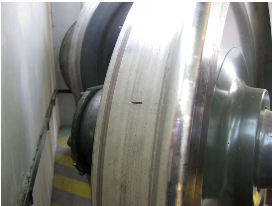
Рисунок 1 - Колесная пара с искусственным дефектом
