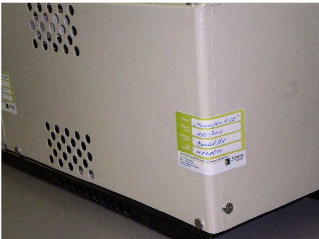
Рисунок 3. Место 3 пломбирования для защиты от несанкционированного доступа
