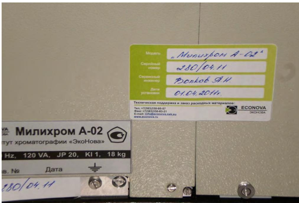
Рисунок 1. Место 1 пломбирования для защиты от несанкционированного доступа
