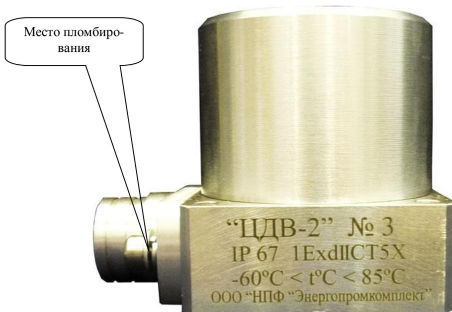
Рисунок 1 – Внешний вид датчика вибрации цифрового «ЦДВ»
