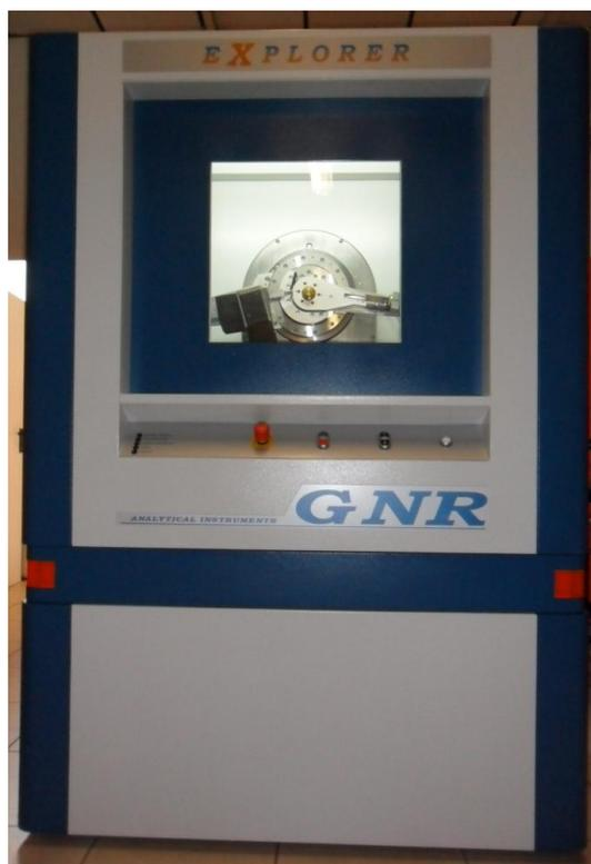
Рисунок 1 - Дифрактометр рентгеновский EXPLORER
