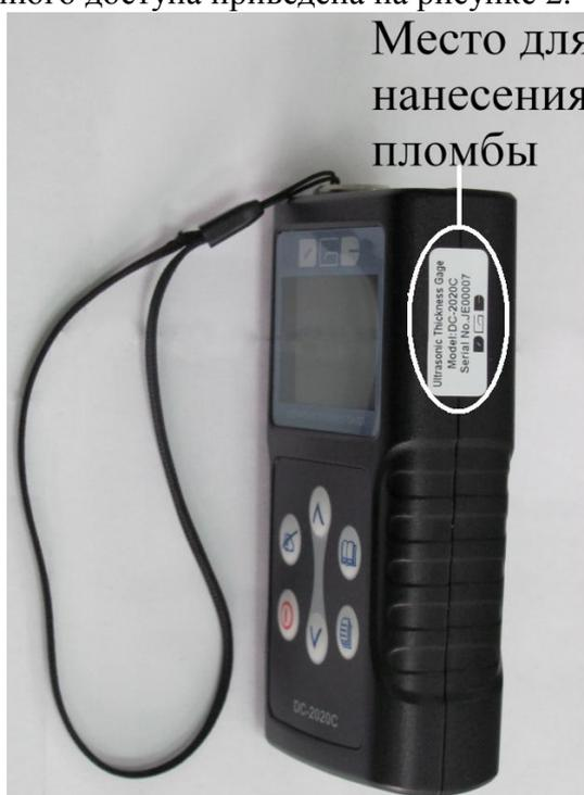
Рисунок 2 - Схема пломбировки от несанкционированного доступа
