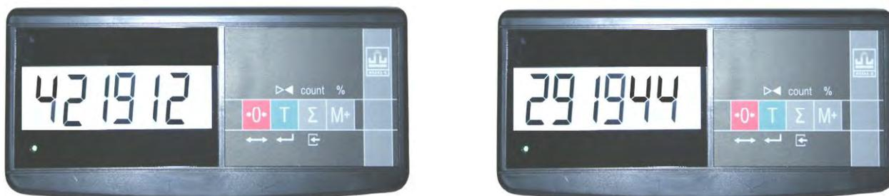
Рисунок 4 – Индикация кода юстировки
