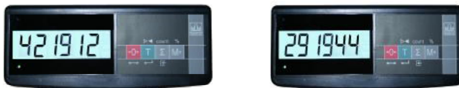
Рисунок 4 – Индикация кода юстировки
