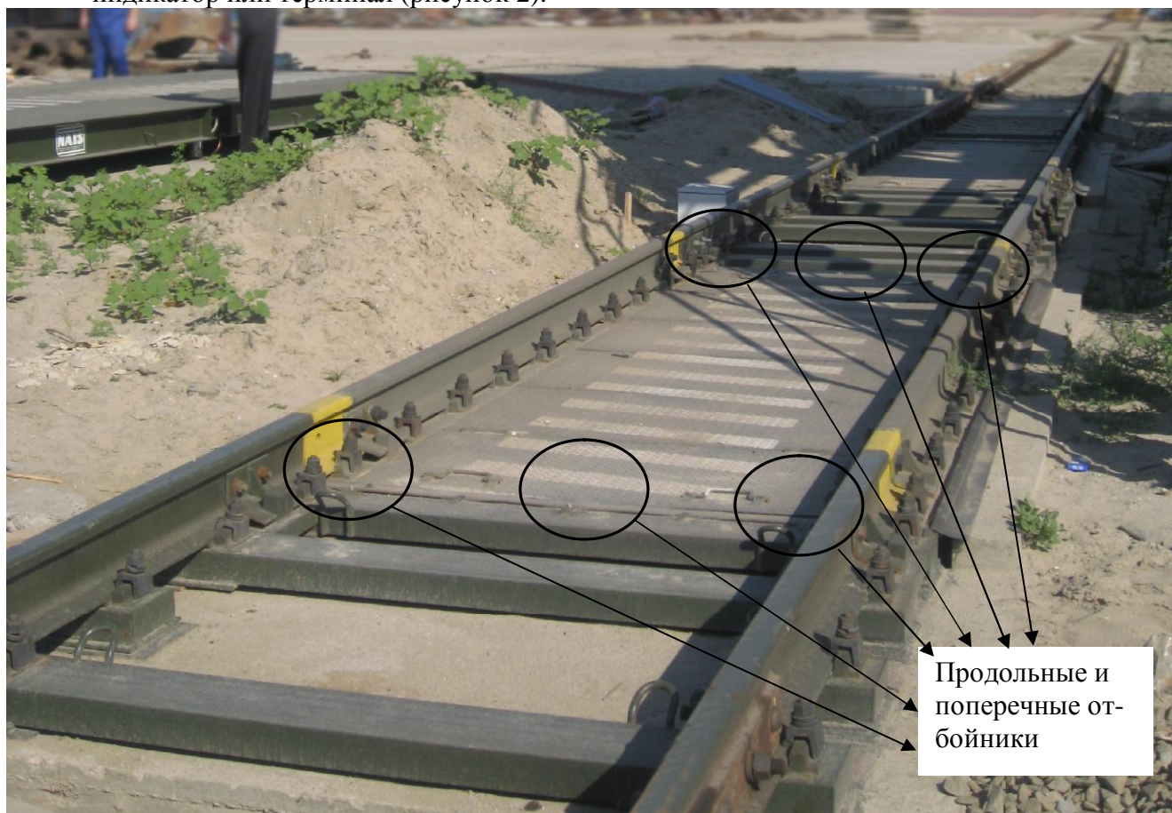
Рисунок 1 - Фотография вагонных тензометрических весов ВВТ
