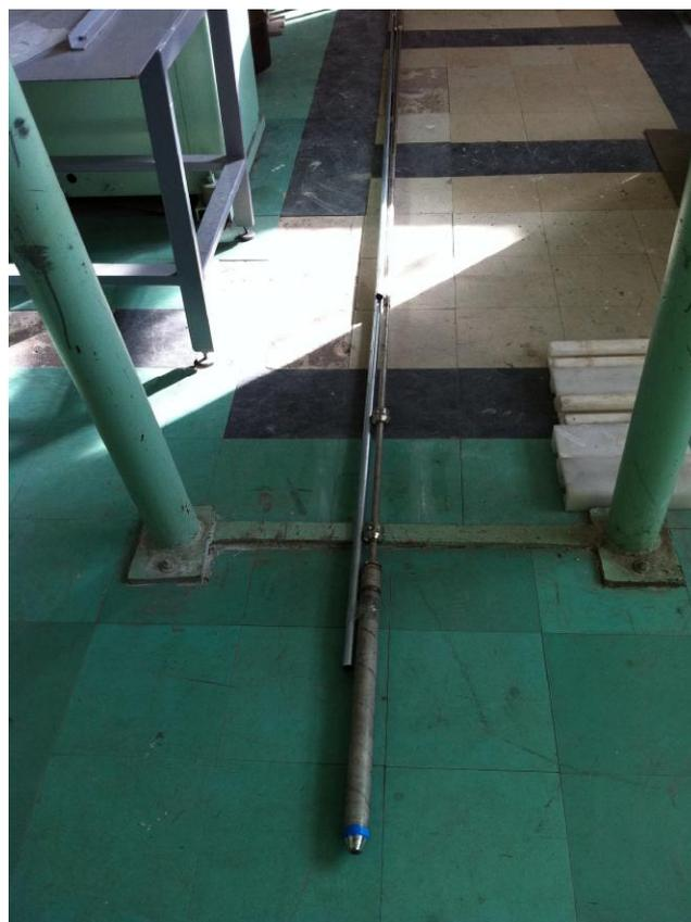
Рисунок 2 — Внешний вид подвески с ионизационной камерой ПИК8 ССКГО
