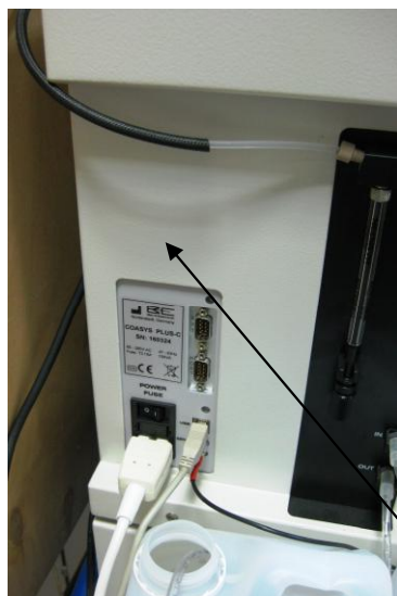
Рисунок 2 - Схема маркировки коагулометра автоматического Coasys Plus C
