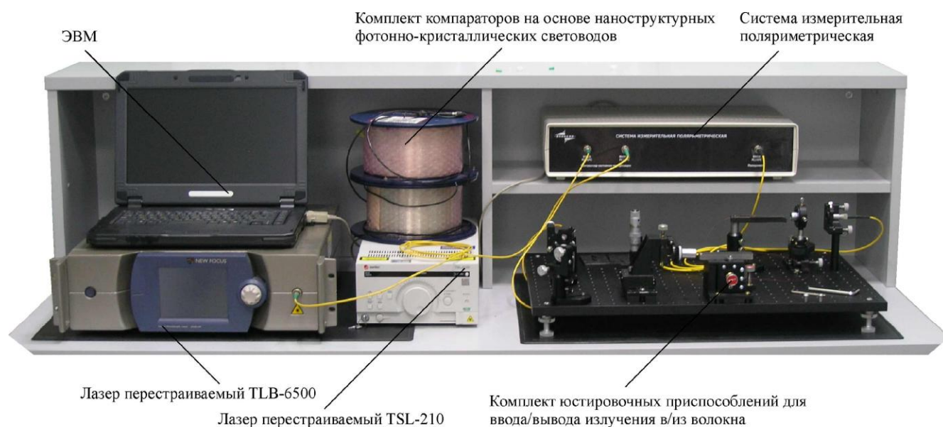
Рисунок 3 - Схема маркировки приборов, входящих в установку для измерения поляризационной модовой дисперсии фотонно-кристаллических световодов
