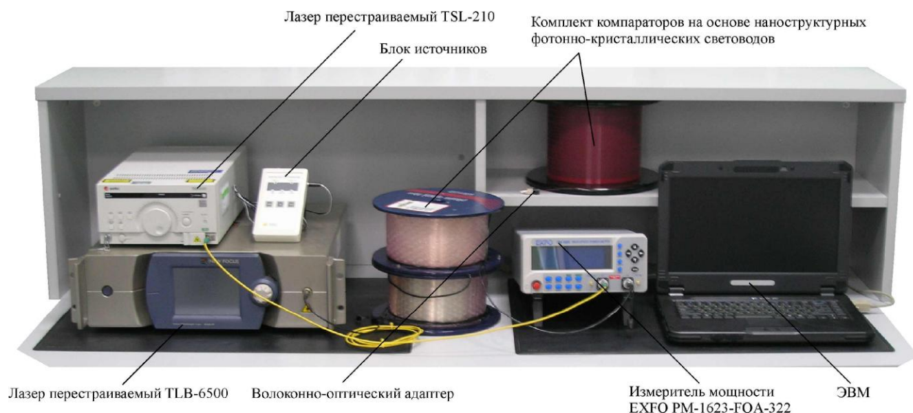
Рисунок 4 – Схема маркировки приборов, входящих в установку для измерения спектрального ослабления фотонно-кристаллических световодов
