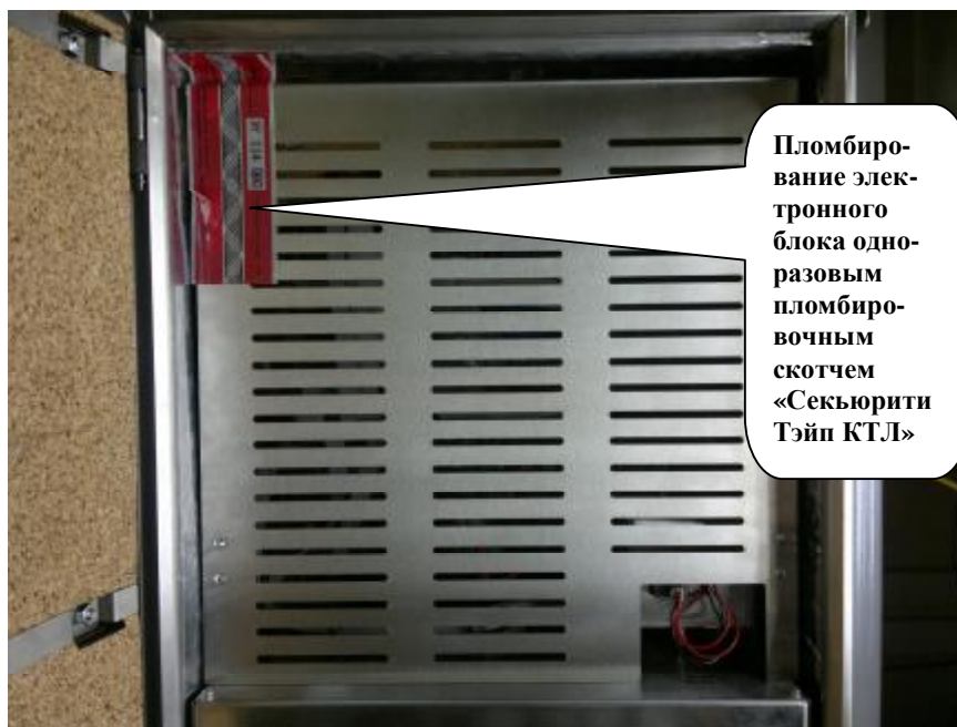
Рисунок 2 - Вид места пломбировки электронного блока анализатора «ИнтеГаз»
