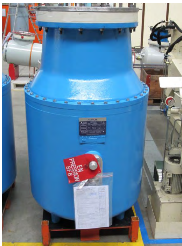
Внешний вид трансформаторов напряжения UFV 550 и место пломбирования
