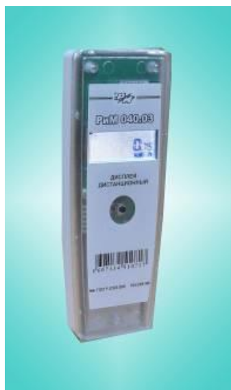
Рисунок 3 – Фотография общего вида и место установки пломбы изготовителя дисплея дистанционного РиМ 040.03 (одно из исполнений)
