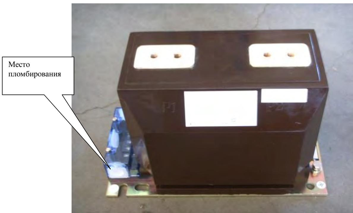
Первичные и вторичные обмотки залиты компаундом, который обеспечивает основную изоляцию и формирует корпус трансформатора. Выводы первичной обмотки выведены на верхнюю часть литого корпуса в виде контактных площадок с двумя отверстиями для болтов М12. Вторичные обмотки выведены в литую коробку для зажимов, закрытую пластмассовой крышкой и расположенную у основания трансформатора на узкой боковой стенке. Крышка, закрывающая зажимы, пломбируется для исключения несанкционированного доступа.
