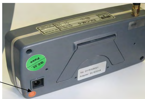
Рисунок 2 Схема пломбировки от несанкционированного доступа.
