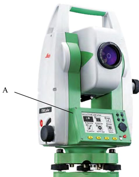
Для предотвращения несанкционированного доступа к внутренним частям Leica FlexLine plus производится пломбировка панели управления в месте обозначенном «А».
