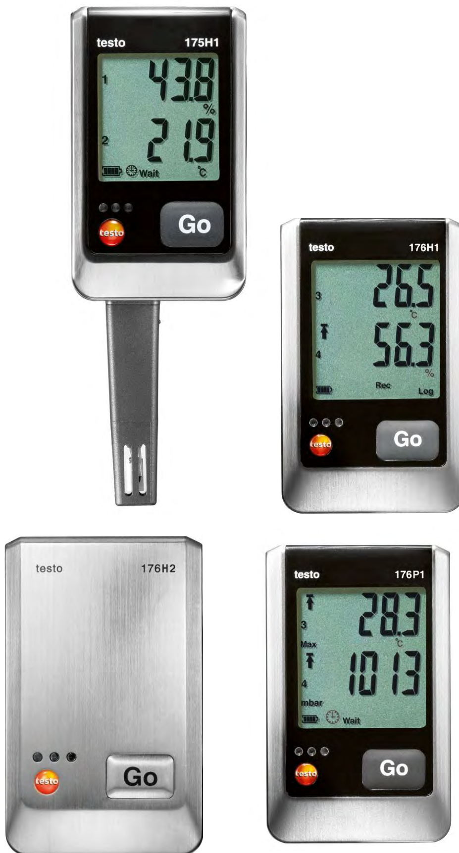
Рис. 1 Общий вид измерителей комбинированных Testo 175-H1, Testo 176-H1, Testo 176-P1, Testo 176-H2.
