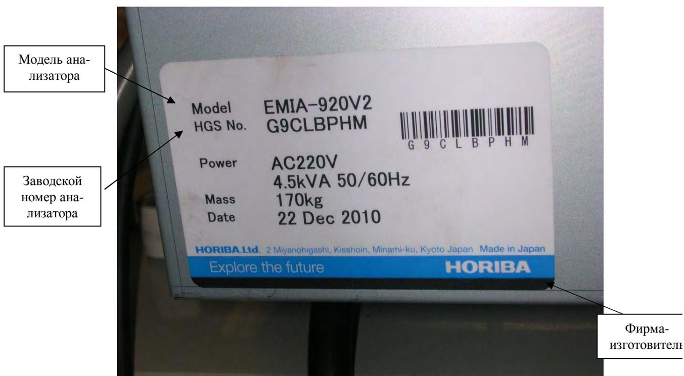
Рисунок 2 Схема маркировки
