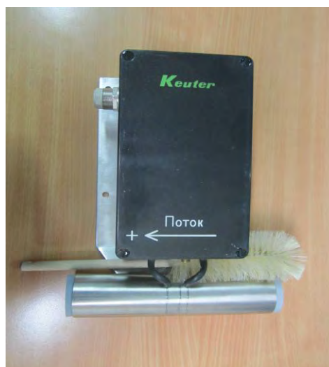
Рисунок 2. Внешний вид измерительного первичного преобразователя ADM6-W-3.07 с сужающим устройством
