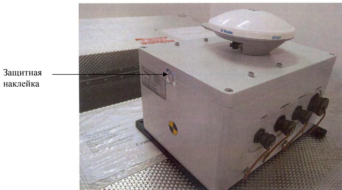
Рисунок 3 – схема размещения наклейки на антенном блоке с приемником GPS
