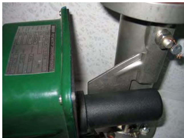
Рисунок 2.2 - Схема пломбирования ротаметров ЭМИС-МЕТА 215
