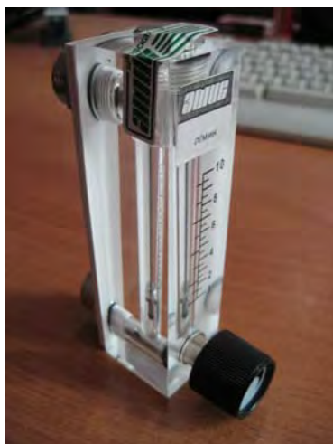
Рисунок 2.1 - Схема пломбирования ротаметров ЭМИС-МЕТА 210
