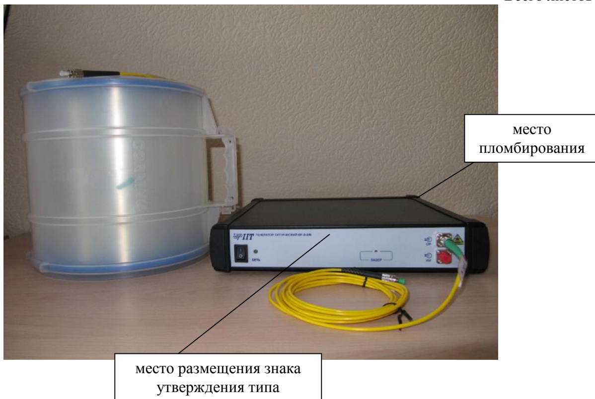
Рисунок 1 – Внешний вид рабочего эталона с указанием мест пломбирования и размещения знака утверждения типа
