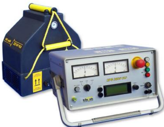
Установка КРГ 20 кV VLF
