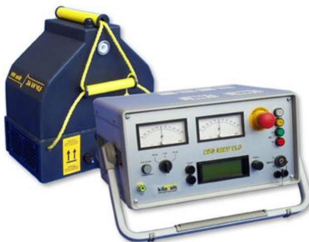
Установка КРГ 36 кV VLF
