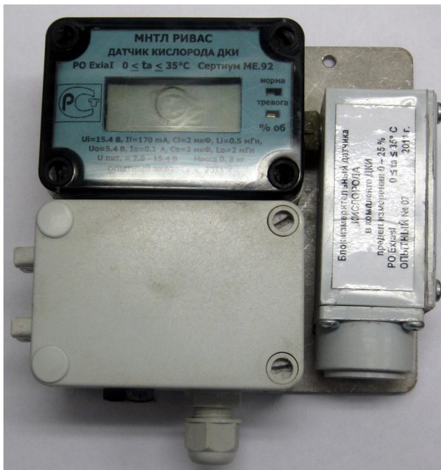
Рисунок 1 – Датчик кислорода искробезопасный ДКИ, внешний вид
