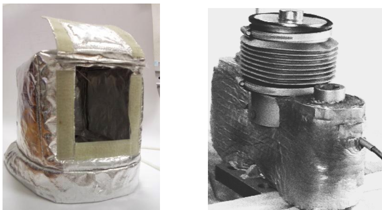
Рисунок 1 – Весоизмерительный датчик оснащенный термочехлом
