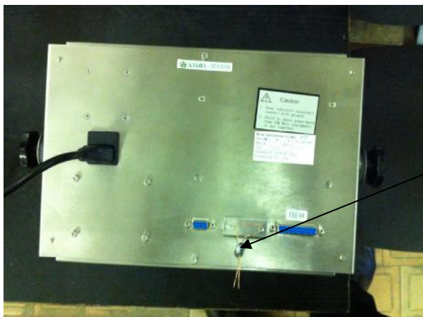
Рисунок 3 Схема пломбировки от несанкционированного доступа и обозначение места для нанесения оттиска клейма индикатора СТТ-А.
