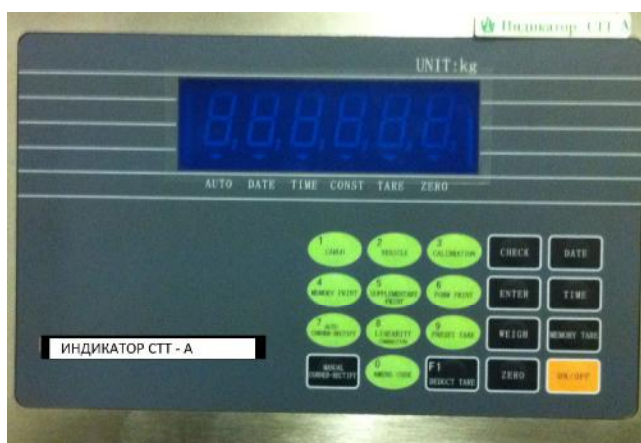
Рисунок 4 Внешний вид индикатора СТТ-А
