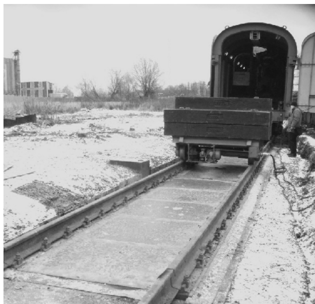
Рисунок 5 Общий вид весов стационарных электронных Альфа АВ-В
