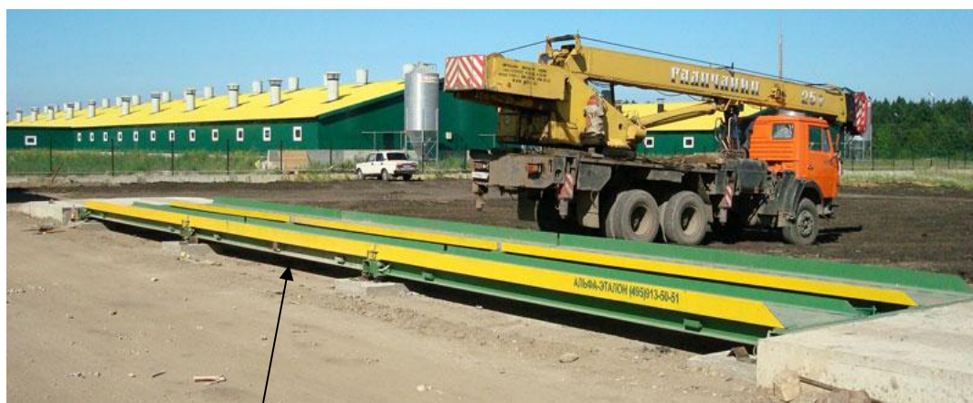
Рисунок 6 Общий вид весов стационарных электронных Альфа АВ-А Маркировка весов стационарных электронных Альфа АВ
