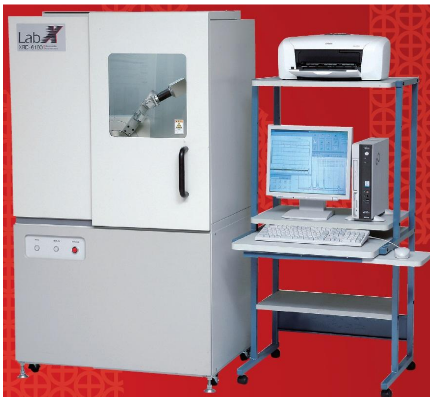
Рисунок 1 – Общий вид дифрактометра рентгеновского XRD-6100
