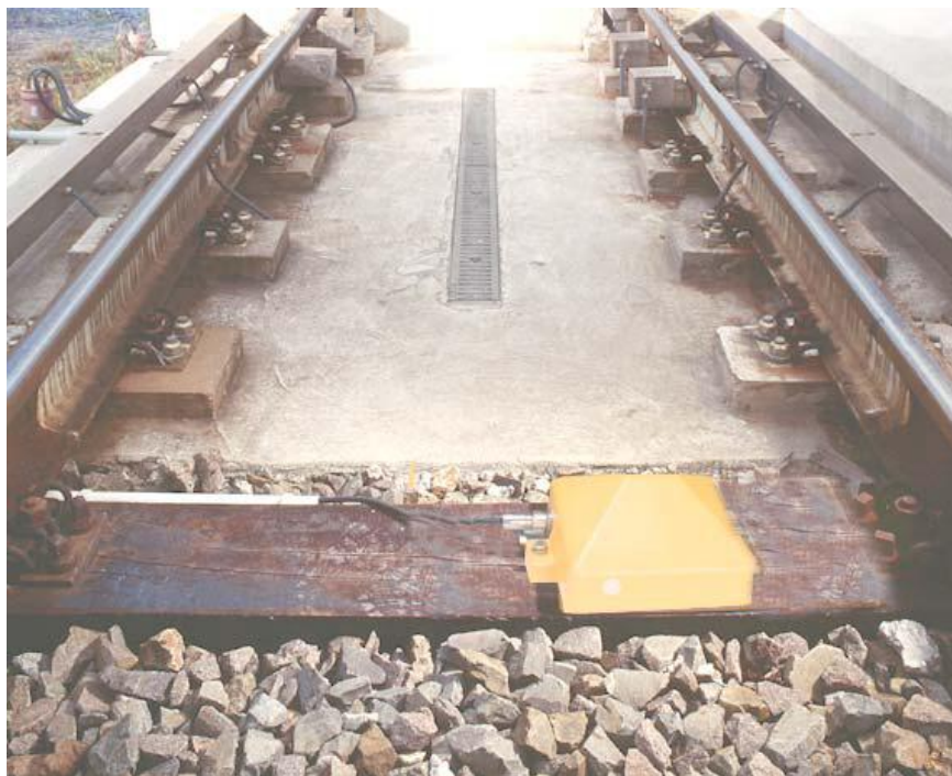
Рисунок 1 – Общий вид модуля измерительного обнаружения трещин на поверхности катания колес измерительного комплекса ARGUS 2 диагностики колесных пар подвижного состава
