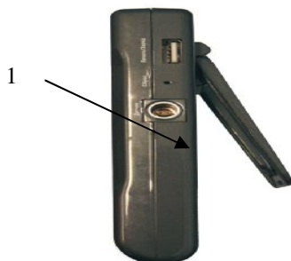
Рисунок 2. - схема пломбировки твердомера МИНИКОН 960. 1 - место пломбировки.
