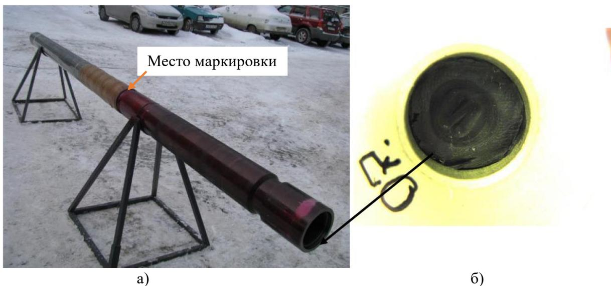
Рисунок 1 – Системы забойные инклинометрические ЗТК
