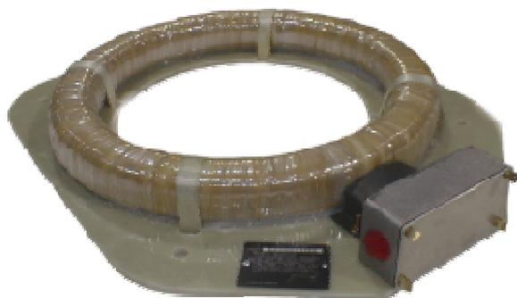
Первичной обмоткой трансформатора является токоведущая шина аппарата. Вторичные обмотки равномерно намотаны на ленточные тороидальные магнитопроводы и обмотаны изолирующей лентой. Выводы вторичных обмоток расположены в коробке вторичных выводов, закрытой крышкой с возможностью пломбирования для предотвращения несанкционированного доступа. Трансформаторы могут выполнять одновременно функции защиты и измерения. Во всех
