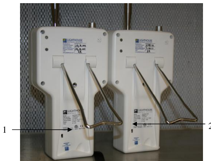
Рисунок 2 – Схема пломбировки от несанкционированного доступа
