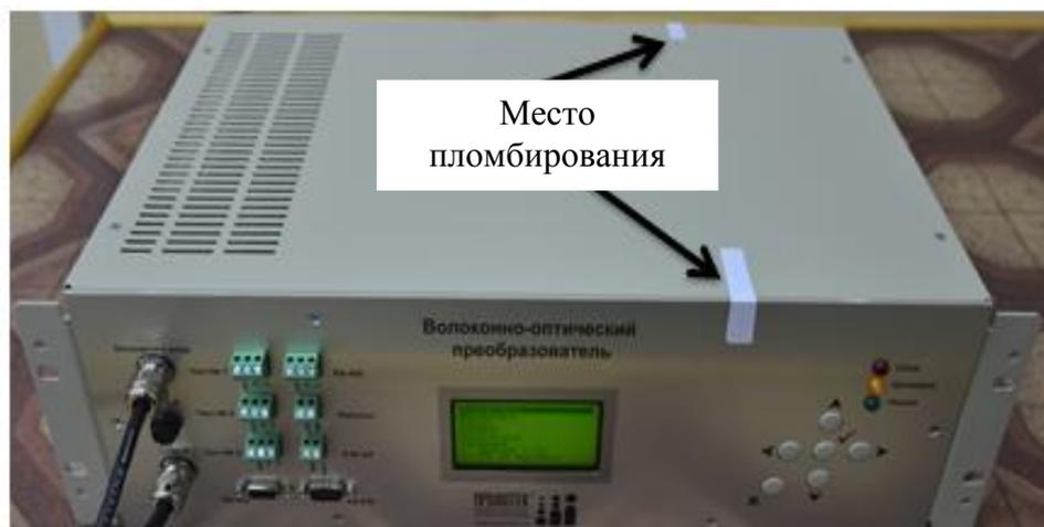
Рисунок 1 – Внешний вид и место пломбирования
