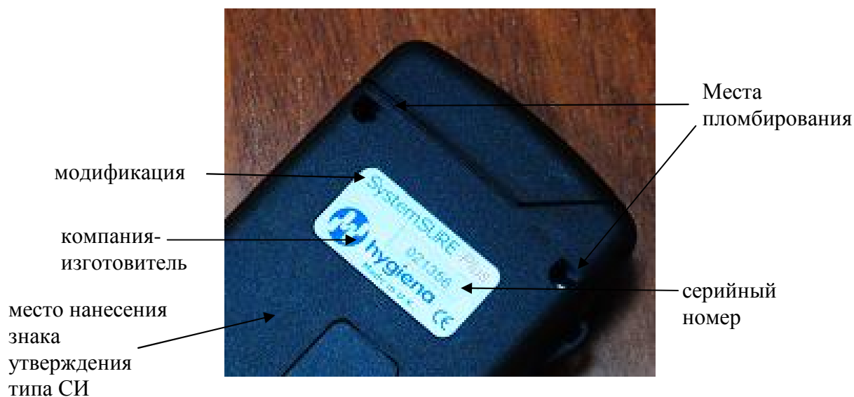
Рисунок 2 - Схема маркировки и пломбирования
